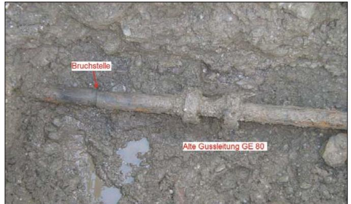
△ Seit einiger Zeit ist in unserem Bauhof ein neues **Lecksuchgerät** im Einsatz, mit dem Wasseraustrittsstellen im Trinkwasserleitungssystem mit großer Präzision geortet werden können. Bewährt hat sich das Gerät bereits im Februar, wo im Bereich der Fa. Dobernik ein Leck geortet wurde, aus dem täglich mehrere tausend Liter Wasser entwichen sind.
